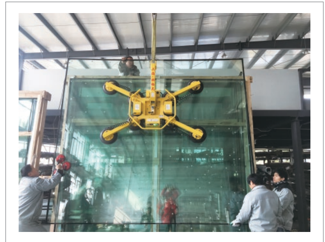
中空夹胶玻璃室内装箱搬运 直流八爪吸吊设备 HP-GX600-8S (600KG)
