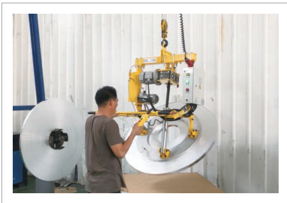
铝卷90度电动翻转搬运 交流单腔式铝卷吸吊设备 HP-CC250-1S (250KG)
