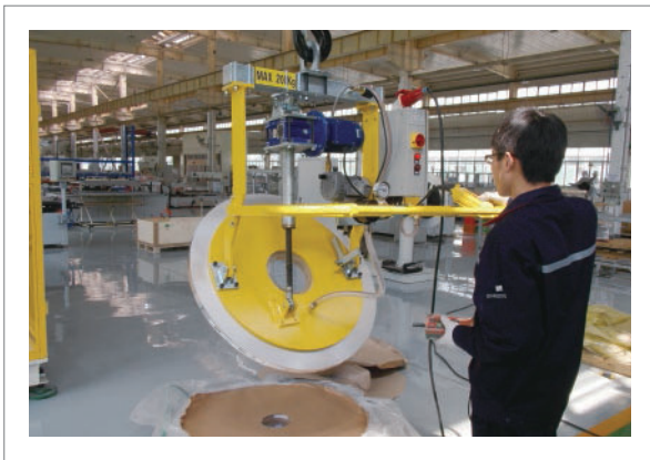
铝卷90度电动翻转搬运 交流单腔式铝卷吸吊设备 HP-CC200-1S (200KG)
