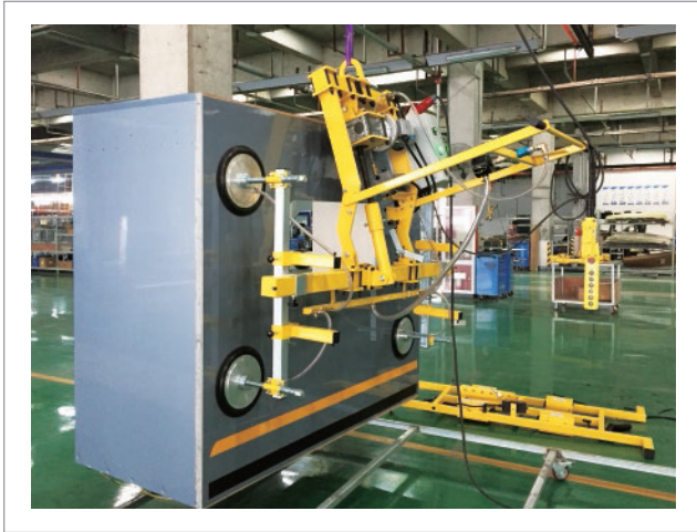
房车厢体90度电动翻转搬运 交流四爪吸吊设备 HP-DF400-4S (400KG)
