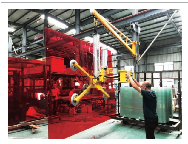
夹胶玻璃进釜-气动升降 气动90度翻转 HP-GFQ400-6S (400KG)
