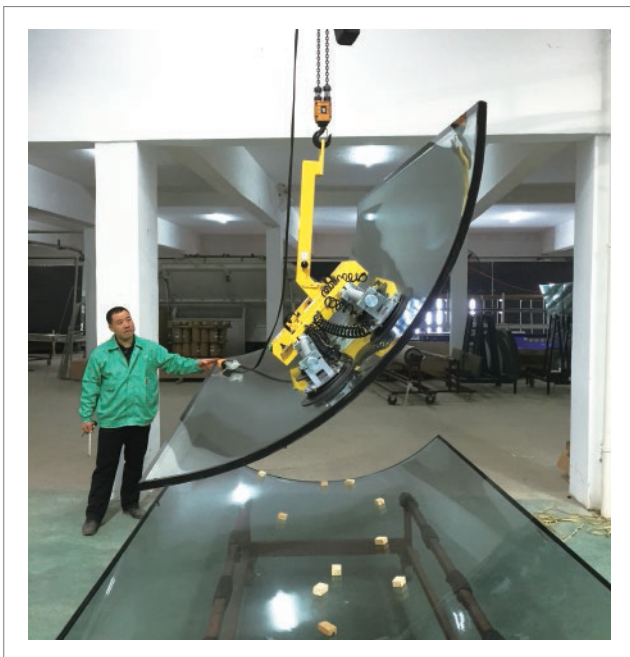
弯弧玻璃手动翻转旋转搬运 直流八爪吸吊设备 HP-GA400-8S (400KG)
