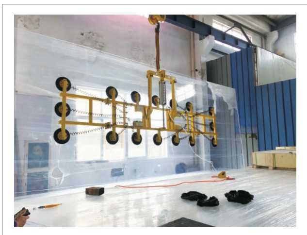
亚克力90度气动翻转搬运 直流十六爪吸吊设备 HP-GHQ1500-16S (1500KG)
