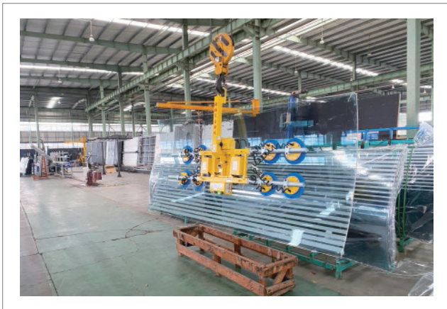
弯弧玻璃手动翻转旋转搬运 直流八爪吸吊设备 HP-GA400-8S (400KG)
