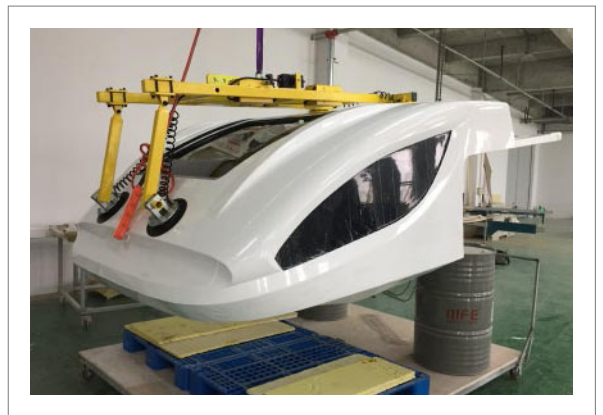
房车车顶水平搬运 直流无线遥控式吸吊设备 HP-C100-4S (100KG)
