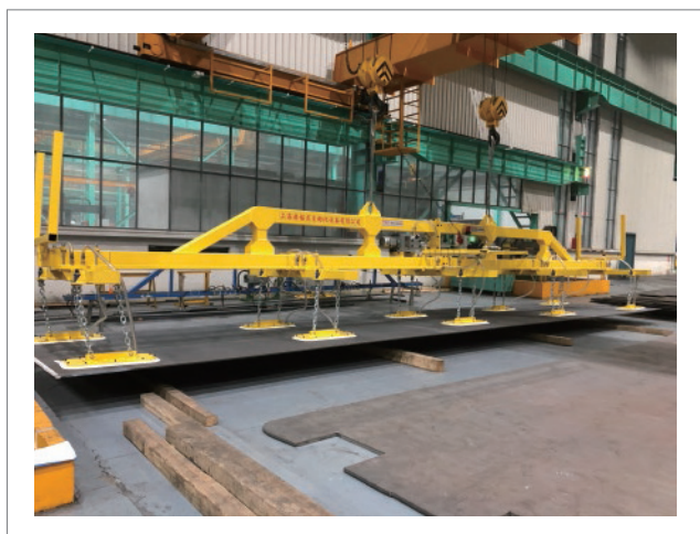
不锈钢板水平搬运 交流十爪吸吊设备 HP-BLJ10000-10S (10T)
