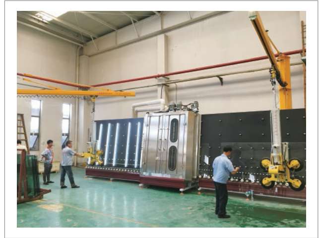
清洗机上下片-气动升降 气动90度翻转加旋转 HP-GFX250-4S (250KG)
