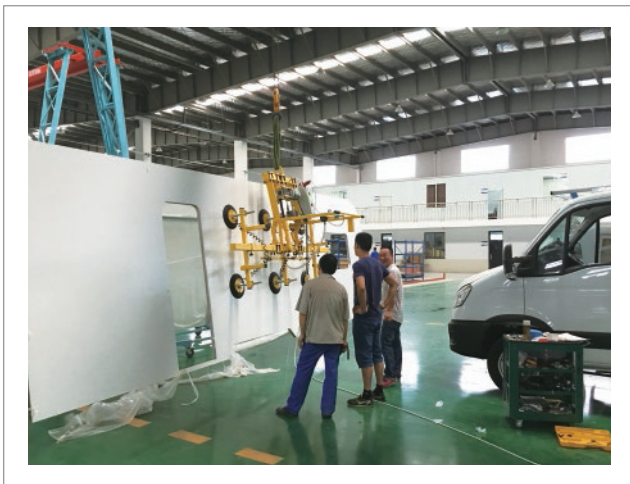
房车厢体90度电动翻转搬运 交流六爪吸吊设备 HP-DF600-6S (600KG)
