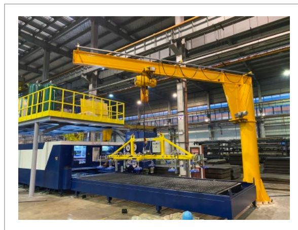
电动行走-电动摆臂-电动升降(工字钢) HP-LZ-1000KG
