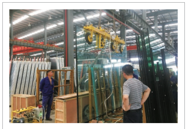
双面夹式垂直搬运 交直流双面夹式吸吊设备 HP-C500-8S (500KG)
