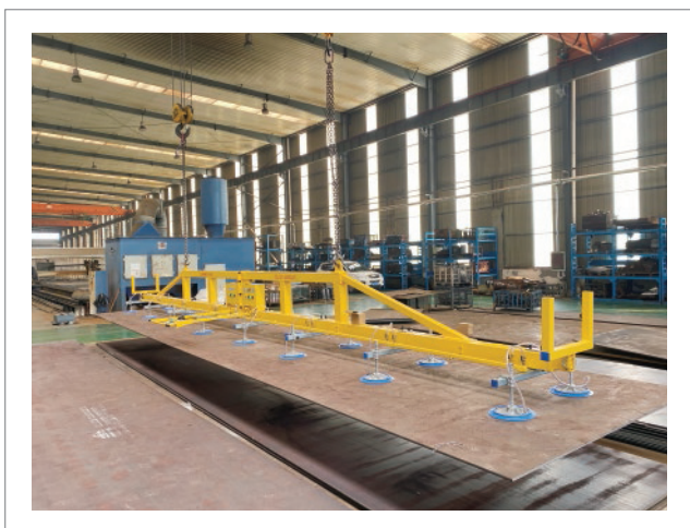
碳钢板水平搬运 (双系统) 直流十六爪吸吊设备 HP-BLZ3000-16S (3000KG)
