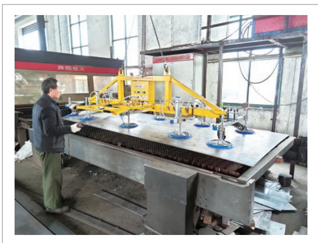
不锈钢板水平搬运 直流十爪吸吊设备 HP-BSZ2000-10S (2000KG)
