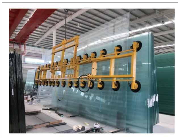
原片玻璃90度手动翻转搬运(双系统) 直流三十爪吸吊设备 HP-GH3000-30S (3000KG)
