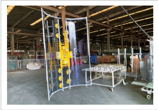
弯弧玻璃手动翻转旋转搬运 直流十爪吸吊设备 HP-GA500-10S (500KG)
