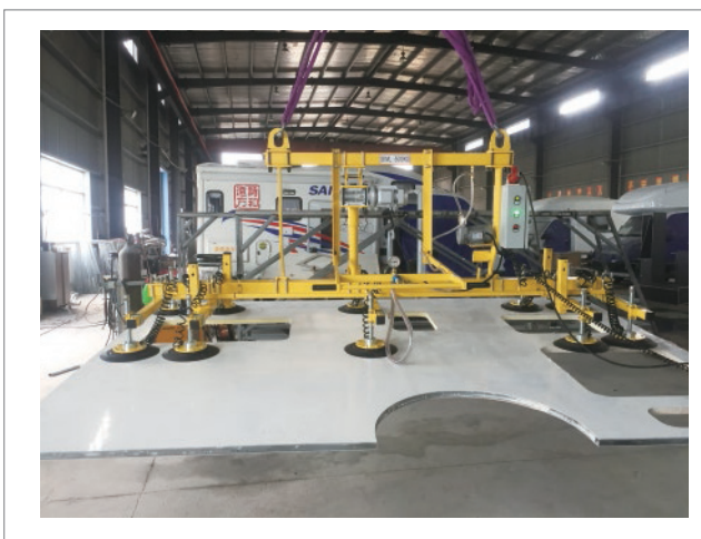
房车厢体90度电动翻转搬运 交流十爪吸吊设备 HP-DF1000-10S (1000KG)
