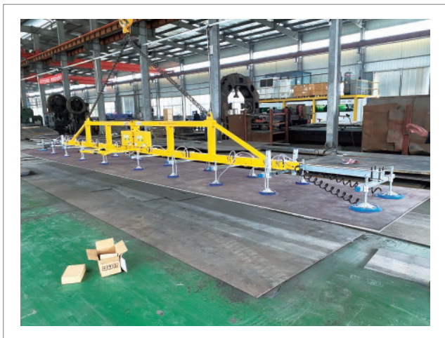
碳钢板水平搬运 (双系统) 直流二十爪吸吊设备 HP-BLZ2000-20S (2000KG)
