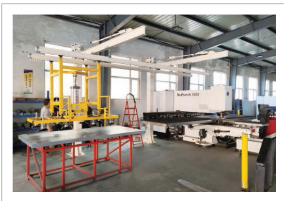
不锈钢板水平搬运 气动八爪吸吊设备 HP-BSC300-8S (300KG)
