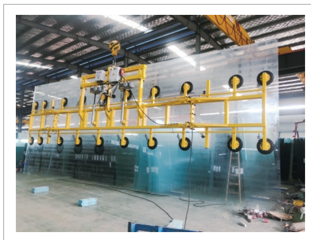
原片玻璃90度电动翻转搬运 交流二十爪吸吊设备 HP-GHD2000-20S (2000KG)
