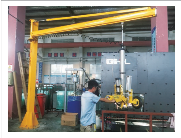
打胶机下片-气动升降 气动90度翻转加旋转 HP-GFX150-2S (150KG)
