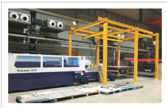
电动行走-电动升降(KBK导轨+工字钢)(500KG)
