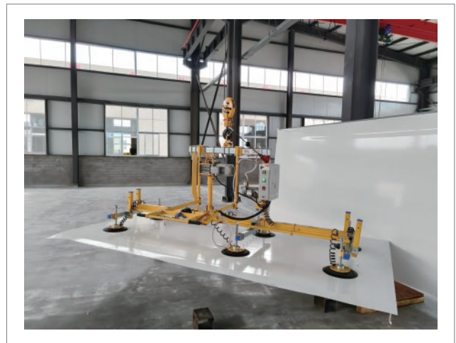
冷藏车厢体90度电动翻转搬运 交流六爪吸吊设备 HP-DF600-6S (600KG)
