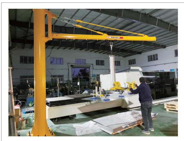
不锈钢板水平搬运 气动六爪吸吊设备 HP-BSQ500-6S (500KG)
