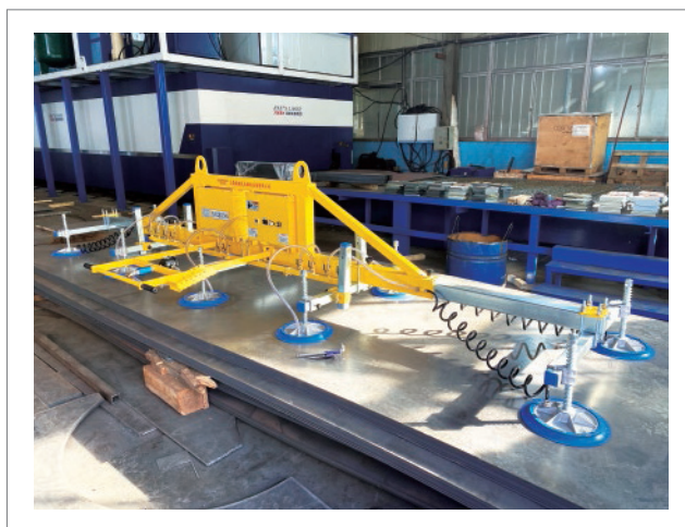
碳钢板水平搬运(长续航版) 直流十爪吸吊设备 HP-BSZ2000-10S (2000KG)
