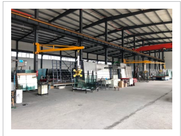
手动行走-手动摆臂 (KBK导轨) HP-QB500KG
