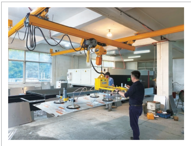
不锈钢板水平搬运 交流六爪吸吊设备 HP-BSJ1000-6S (1000KG)
