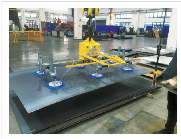
碳钢板水平搬运 直流六爪吸吊设备 HP-BSZ1000-6S (1000KG)
