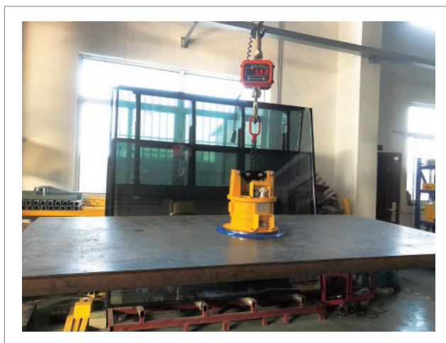
碳钢板水平搬运 单头无动力真空吸吊设备 HP-WDL800-1S (800KG)
