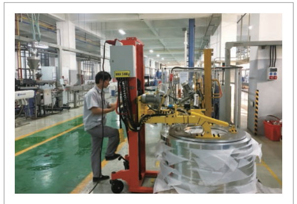
叉车式90度电动翻转搬运 移动式铝卷吸吊设备 HP-CC500-2S (500KG)
