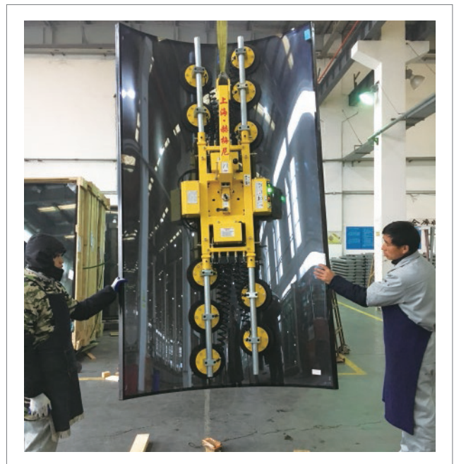
弯弧玻璃手动翻转旋转搬运 直流十爪吸吊设备 HP-GA500-10S (500KG)
