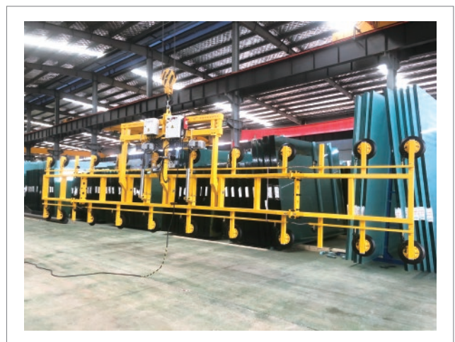
原片玻璃90度电动翻转搬运 交流二十爪吸吊设备 HP-GHD2000-20S (2000KG)
