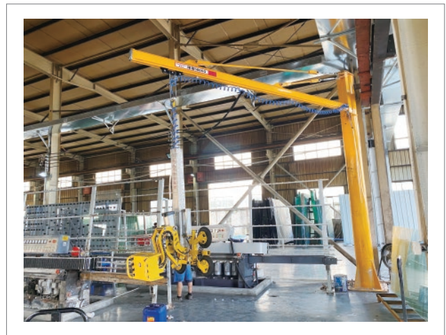
磨边机上下片-气动升降 气动90度翻转加旋转 HP-GFX350-4S (350KG)
