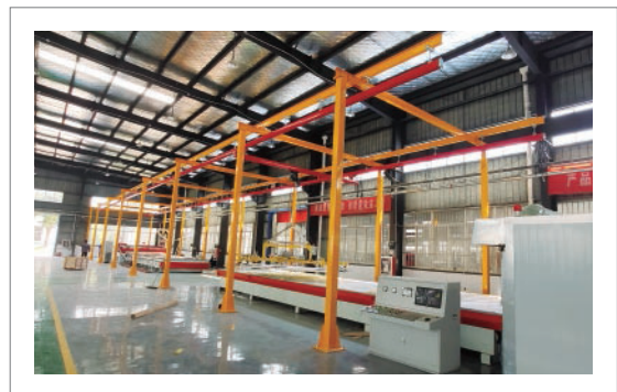
电动行走-电动升降(KBK导轨+工字钢)(1000KG)
