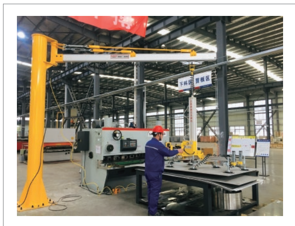
手动行走-手动摆臂(铝型材导轨) HP-LZ-500KG
