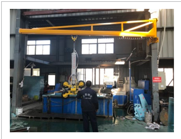
手动行走-手动摆臂 (KBK导轨) HP-QB500KG
