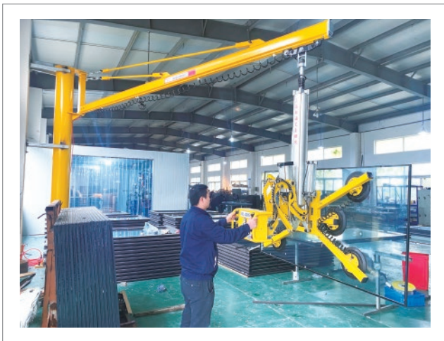
玻璃附框搬运-气动升降 气动90度翻转加旋转 HP-GFX350-4S (350KG)
