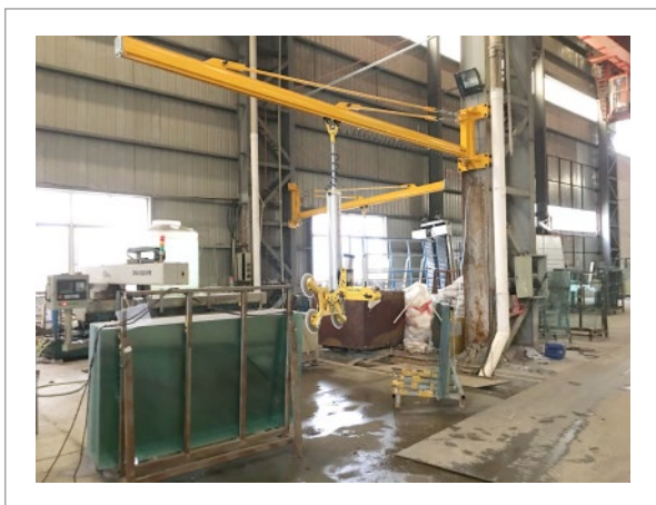
手动行走-手动摆臂 (KBK导轨) HP-QB500KG
