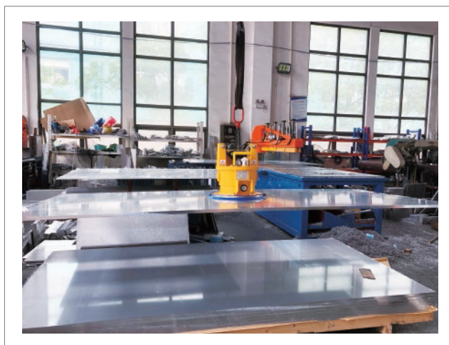
铝切机上料 单头无动力真空吸吊设备 HP-WDL800-1S (800KG)
